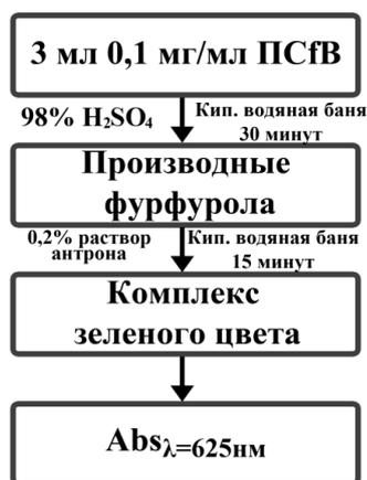
Рис. 1. Схема методики количественного определения ПСfВ
